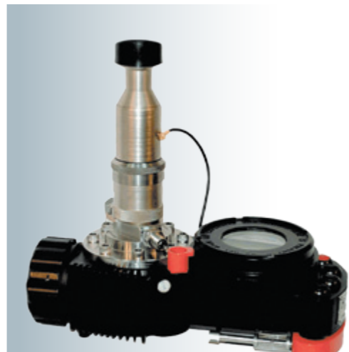
Рис. 7. Анализатор точки росы Hygrovision-BL-mini
